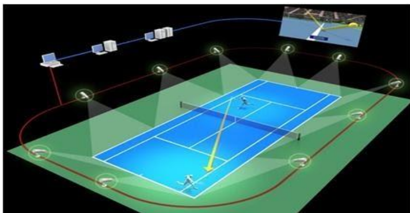
Fig. 4 "Schema di funzionamento del sistema Hawk-Eye"
